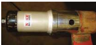
Удаление сайлентблока с использованием гидравлического выпressовщика на 18 тонн..
